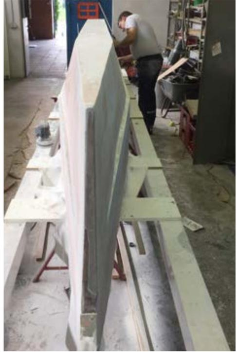
rung soll zum Schutz des Holzes dienen. Nebenbei wird der zweite Rumpf gefertigt und in Kürze von außen laminiert. Sobald beide Rümpfe gefertigt sind kann der Aufbau beziehungsweise das Plattformdeck gefertigt und auf die beiden Rümpfe aufgesetzt werden.
